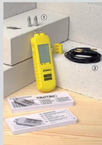
Im Standard-Lieferumfang enthalten sind neben dem T500-Messgerät zwei Überwurfmuttern, zehn Messspitzen (Länge 20 mm, Ø 1,5mm), Elektroden-Schutzkappe, Batterie, Bedienungsanleitung und ein 170 Seiten umfassendes Holzsorten-Verzeichnis.
