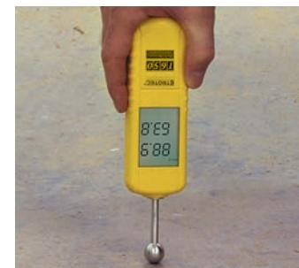
Durch die permanente Echtzeitanzeige der Messwerte auf dem gut ablesbaren Display können feuchte und trockene Wand- oder Bodenflächen schnell detektiert werden. Darüber hinaus ist das Messgerät zur Vorprüfung der Belegreife von Baustoffen bei CM-Messungen geeignet.
